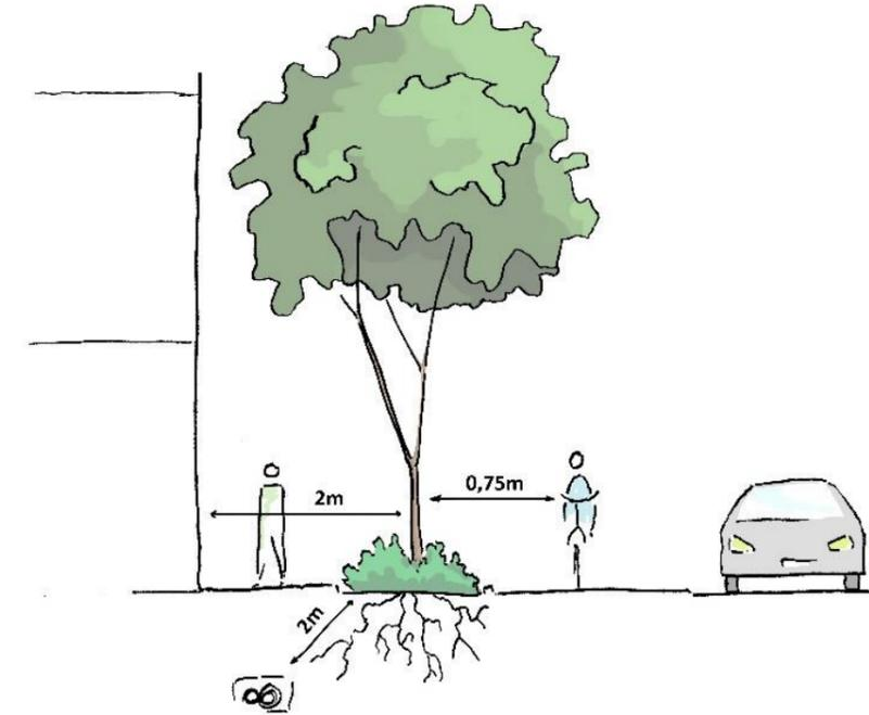
Figure 66 : Coupe de l'espacement entre arbre, cycle, réseau et façade, Source : Ingérop
