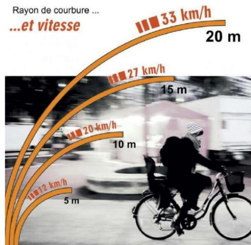
Figure 11 Des rayons de courbures qui optimisent les déplacements à vélo
